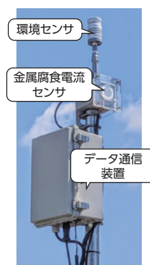
塩分付着監視IoTシステム(左)と台風9号襲来時の塩分付着量の測定結果(右)
