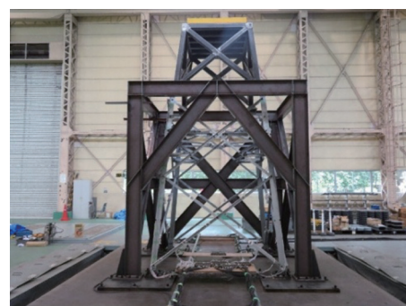
試験体：66kV標準鉄塔下部の実寸大の模型
