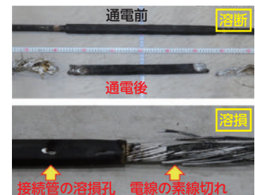
図2 事故電流通電後の溶断と溶損
