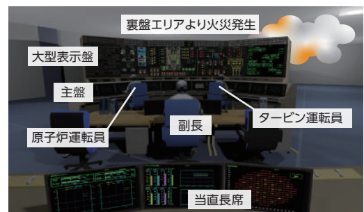
VRプラントシミュレータシステム(当直長の視点)
