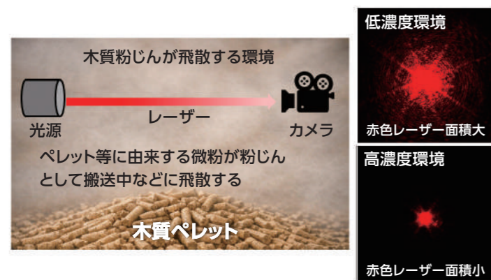
図1 木質粉じん濃度測定法のイメージおよび撮影したレーザー画像 木質粉じんによって減衰したレーザー光をカメラで撮影し、画像解析したレーザー光の面積から濃度を推定します。低濃度環境では赤色のレーザー面積が大きく、高濃度環境では小さくなります。
