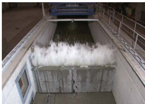
津波・氾濫流水路を用いた防潮堤の越流試験
