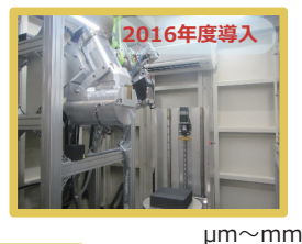
⑥マイクロフォーカスX線CTによる最新断層面沿いの3次元変形構造の詳細観察
