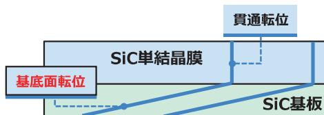
SiC基板と単結晶膜の界面付近で、転位の向きを変えることで、単結晶膜から通電劣化の要因となる基底面転位を排除（貫通転位は通電劣化の要因とならない）
