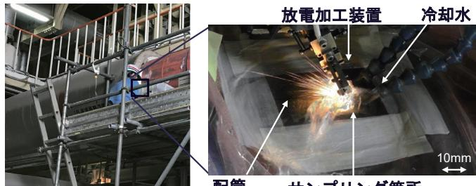
従来比1/8厚(0.5mm)のサンプル試験技術を確立し、実機配管からのサンプル採取を実現
