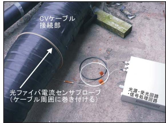
図3 ケーブル接続部への適用イメージ
