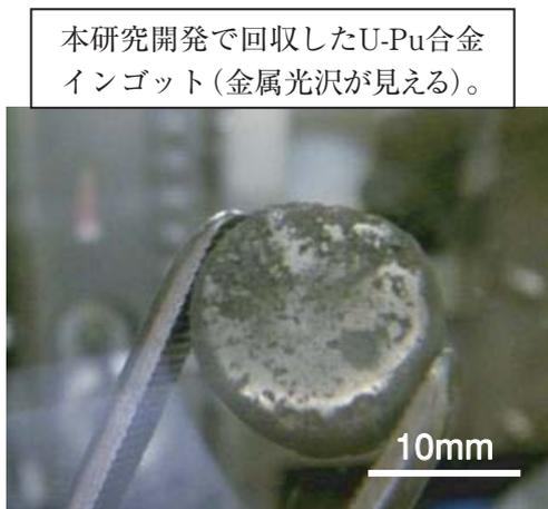
図3 連続プロセス試験で回収したU-Pu合金 (直径:約18mm、重量:約26g、Pu濃度:約25%)
