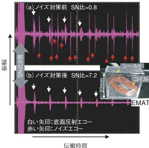
図4 電磁超音波探触子のSN比の改善
