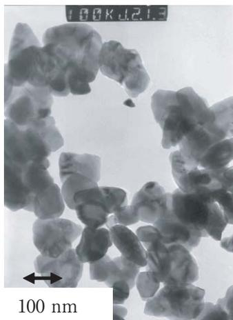
図1 実験室レベルのナノ粒子成長法により合成した  $Ce_{0.9}Gd_{0.1}O_{1.95}$  ナノ粒子のTEM写真
