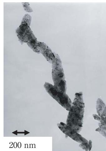
図2 大型製造装置を用いた新ナノ粒子成長法により合成した  $Ce_{0.9}Gd_{0.1}O_{1.95}$  ナノ粒子のTEM写真
