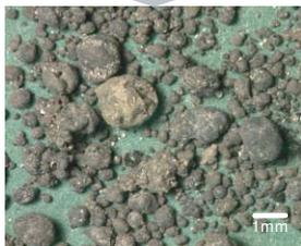
図4 石炭ガス化スラグ軽量細骨材の例
