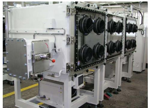
恒温恒湿槽内蔵ガス循環精製機付
