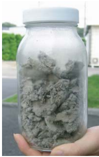
図1 脱水後の下水汚泥
