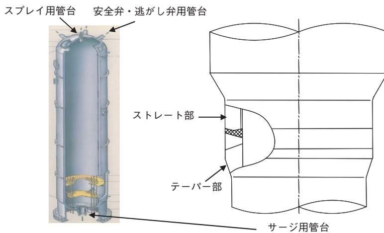
図1 加圧器および管台模式図
