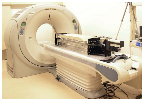
ヘリカルX線CTスキャナー (ベッド上は断層模型実験装置)
