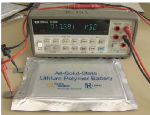
図3 試作4スタック電池の作動状況 (13.69 V、13×8cm平板型、外部加圧無)
