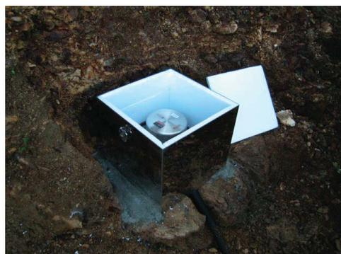
露頭岩盤上に設置された強震計
