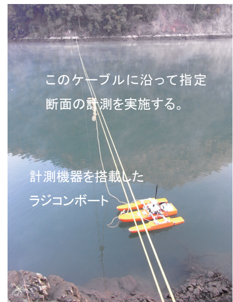
図4 移動式流速分布観測システム
