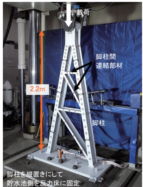
図2 ダムゲートの耐荷力実験
