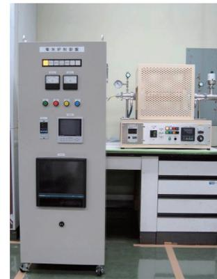
写真2 真空加熱炉（写真右）および真空加熱炉用温度監視装置（写真左）
