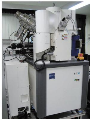
写真1 高分解能電界放出型走査電子顕微鏡
