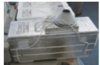
CCDカメラと電荷測定装置を取り付けたビデオゾンデをゴム気球にぶら下げ、それを雪雲の中に投入した。これにより、上空の降水粒子の種類(雪片、あられ、氷晶など)や量、および降水粒子の電荷量を観測した。
