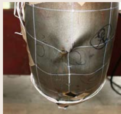
図5 ハイブリッド実験による減肉エルボの面外振動での損傷状況(外径216.3mm、板厚5.8mmの配管使用)
