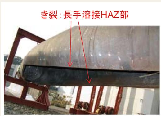
図5 破壊した9Cr鋼実機配管試験体の外観 (温度:650℃、破断時間:約8600時間)
