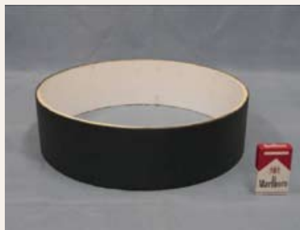
図2 試作した超電導限流器用のφ450mm大型円筒体
