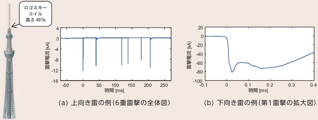
図1 東京スカイツリーで観測された上向き雷と下向き雷の電流波形の観測例
