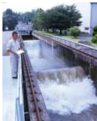
実規模波浪模擬実験のできる大型造波水路 (S54年)
