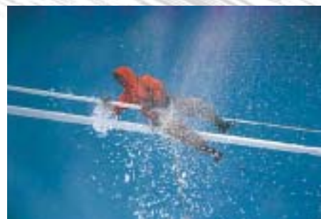
新潟県・枝折峠における超高圧送電線の冰雪害実験 (S34年～)
