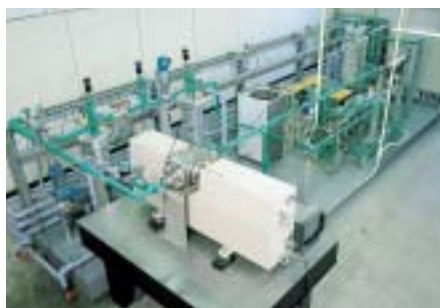
超臨界圧CO 2 ヒートポンプの実験装置 (S59年～、H10年に実用化)
