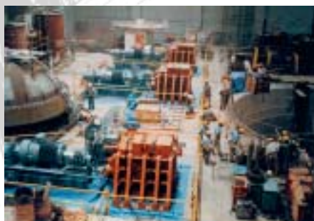
原子力発電所における建屋竣工前検査の起振実験(S52年～)
