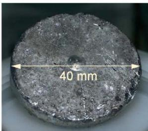
電解精製による、ウラン-プルトニウム-アメリカシウム合金のカドミウム陰極中への回収に成功
