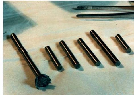
ネプツニウム、アメリシウム、キュリウム、および希土類元素を添加したウラン-プルトニウム-ジルコニウム燃料合金
