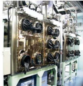
実験室規模電解精製、燃料製造試験グローブボックス（日本原子力研究所、大洗研究所）
