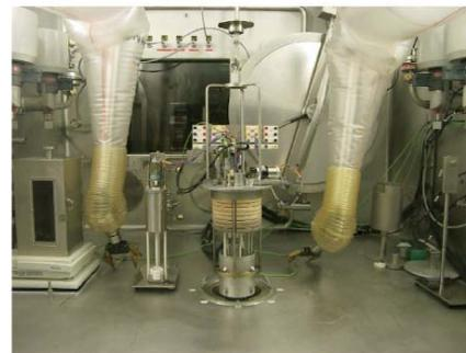
使用済み燃料・実廃液試験セル
