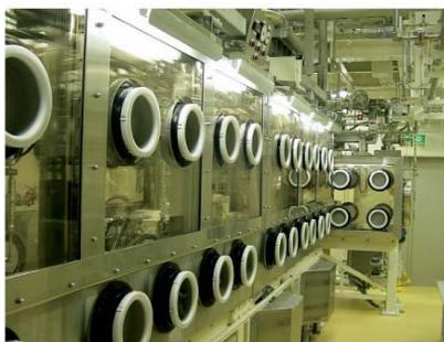
乾式再処理プルトニウム試験グローブボックス
