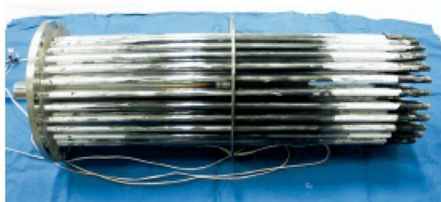
約10kgのウラン-ジルコニウム合金を射出成型法で約100本のモールド束に鑄込むことに成功
