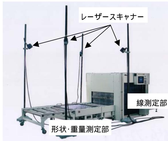
図1 電中研式クリアランスレベル測定装置 (CLALIS)
