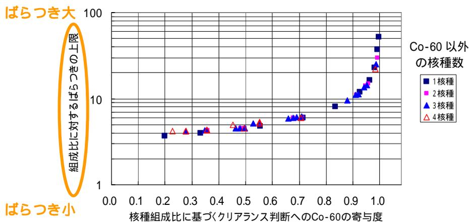
図3 組成比のばらつき誤差の上限の考え方 (簡易法の例)
