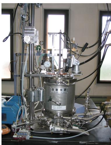
図3 U-Pu-Zr燃料射出鑄造装置
