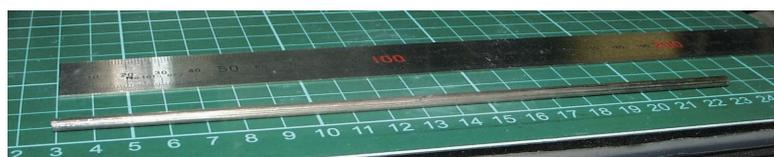
図4 U-Pu-Zr燃料スラグ(U-20wt%Pu-10wt%Zr、200.3mmL)
