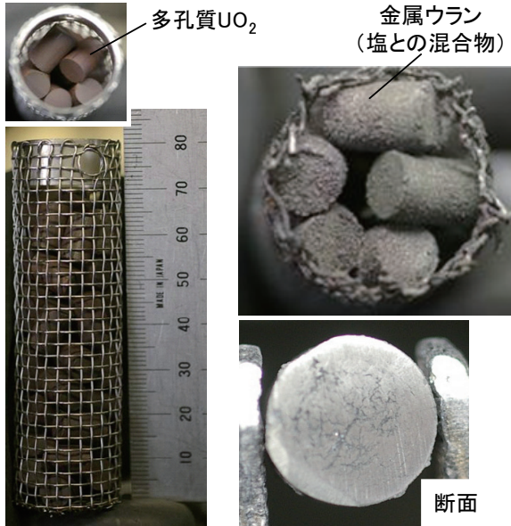
図1 電解還元法を適用した酸化物燃料の乾式再処理プロセス
