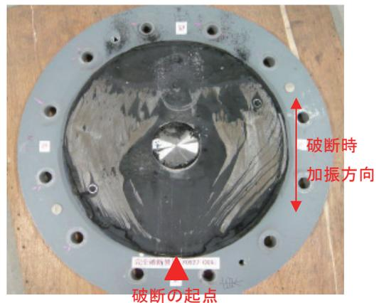
図4 積層ゴムの破断面
