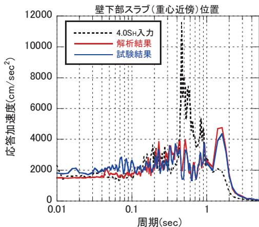
図3 積層ゴム破断時の試験体重心付近での床応答スペクトル(減衰定数 1%)とシミュレーション結果
