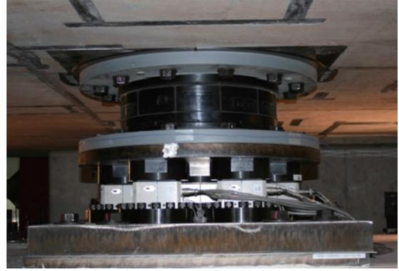
図1 水平免震構造試験体と鉛プラグ入り積層ゴム(実機の約1/3)の設置状況
