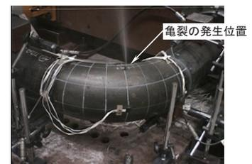
き裂貫通時の試験体
