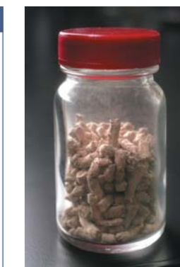
DMEにより常温脱水された下水の汚泥。脱水後は無臭化され、そのまま燃料として利用できる。
