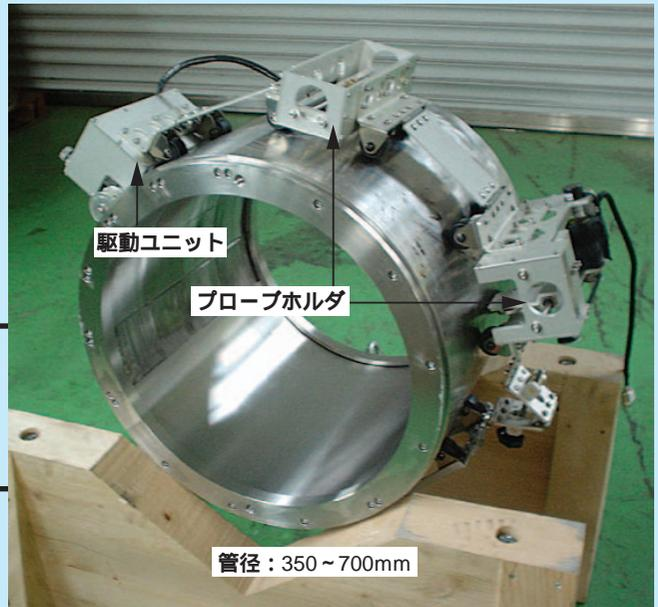
「実機用高性能多機能超音波探傷装置」
