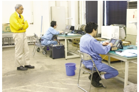
5日間で配管を模擬した10個の試験体について、外から見えない内部のき裂の高さ(深さ)を測定し、その検査・測定システムの精度を審査。
