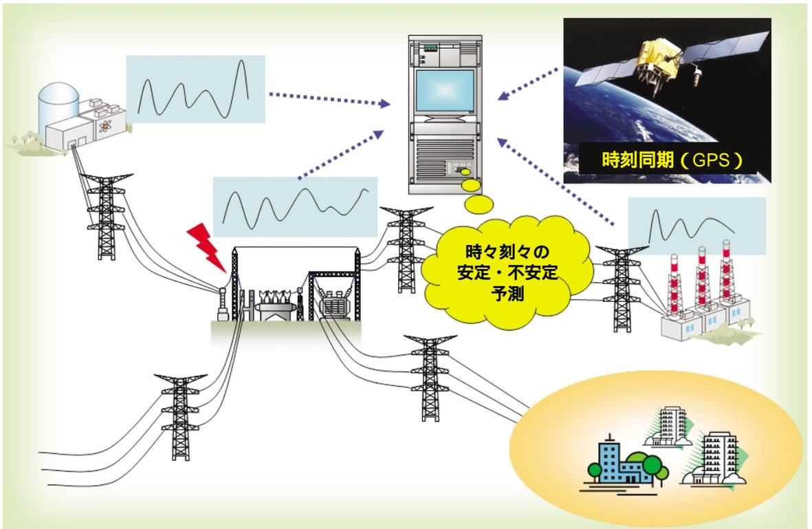
GPS（汎地球測位システム）で同期をとり大規模な系統の安定性をリアルタイムで判定する
