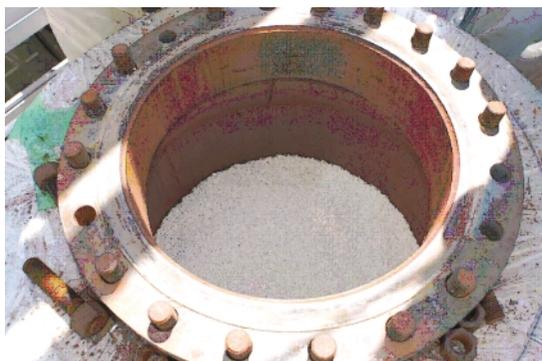
図4 量産され設備に充填したハロゲン化物吸収剤
