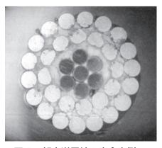
図 1 架空送電線の腐食事例[1]
