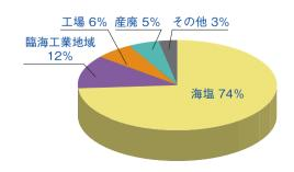
図2 架空送電線の腐食原因[1]
