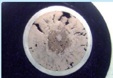
燃焼試験後の金属燃料断面
