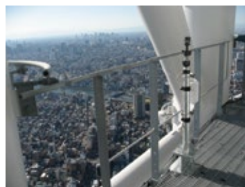
図-9 鉛直観測の様子 上:スカイツリーの観測 下左:水田に設置したマスト 下右:マスト内部のサンブラ
