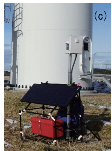
(a)風車、(b)飛翔中の鳥類(オオハクチョウ)、(c)ステレオビジョンによるカメラ観測の様子
