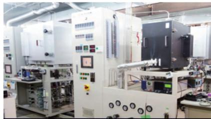
**電解セル(SOEC)/燃料電池(SOFC)評価試験設備**
