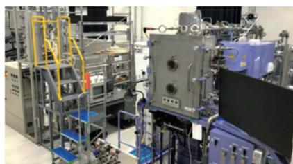
**事故時燃料棒破損試験設備**
