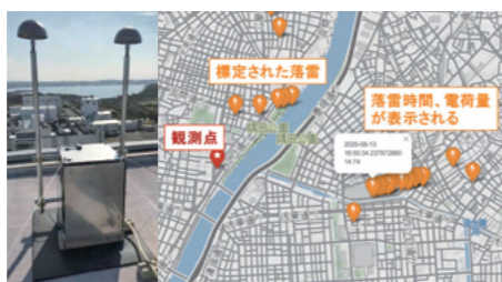
新型落雷位置評定システム(LENTRA)
