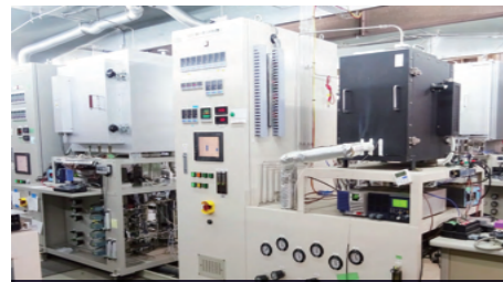
電解セル(SOEC)/燃料電池(SOFC)評価試験設備
