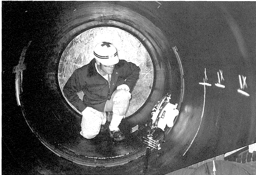
(a) キャスクの内側から超音波による非破壊検査を実施
