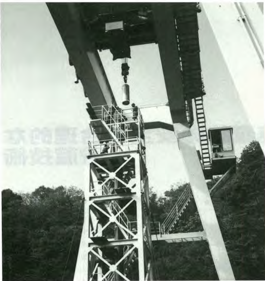
図2-3-2 パッケージの実規模落下実験
