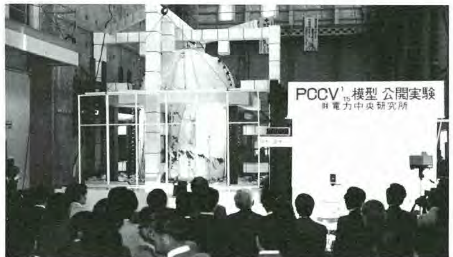
図3-2-9 1/15縮尺PCCVモデルの破壊公開実験
