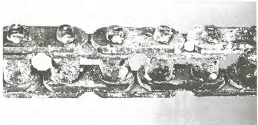
図2-5-12 索引部材のナトリウム付着状況
