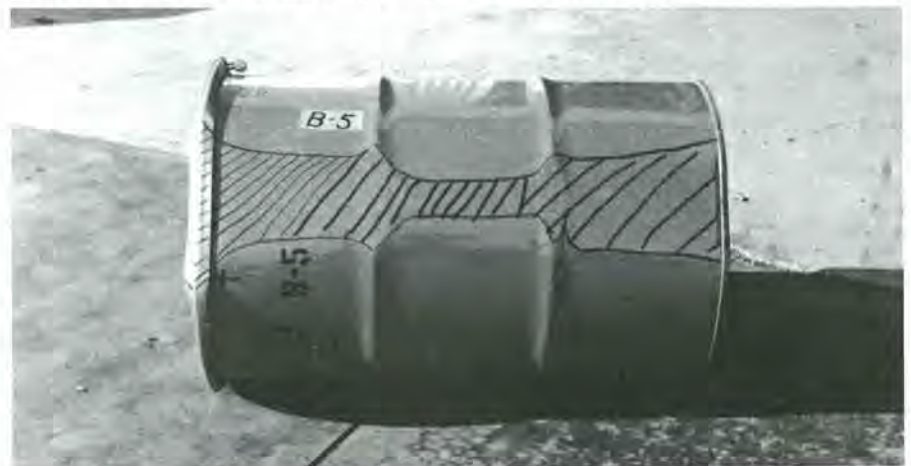
図2-1-9 9 m 落下衝撃実験後のパッケージの変形状況(斜線が変形部分)
