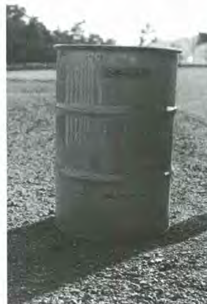
図2-1-10 700kg/cm 2 の水圧荷重を行なった後のパッケージ(ほとんど変形がない：上部空間5 cm以下)
