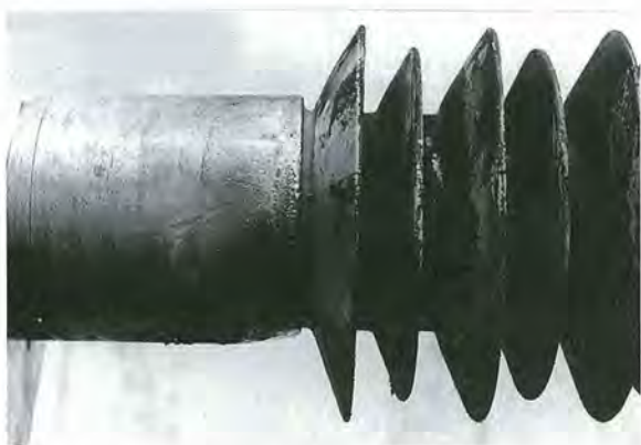
図2-2-8 耐アーク試験後の高分子がいしユニットの表面の状況
