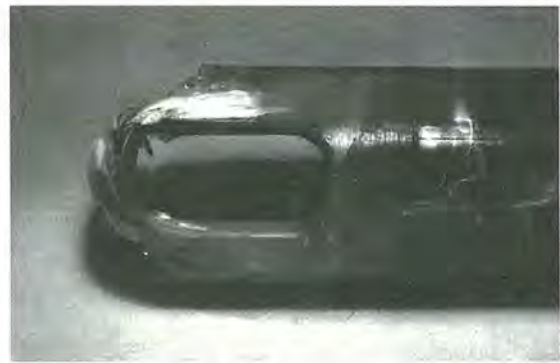
図2-1-16 レーストラックコイル型コアの引張荷重に対する破壊部位
