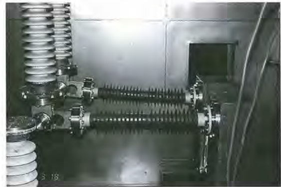
図2-1-22 高分子がいしの電気・機械性能評価試験状況
