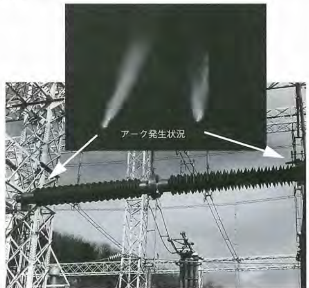
図2-2-6 高分子がいしユニットの耐アーク試験状況
