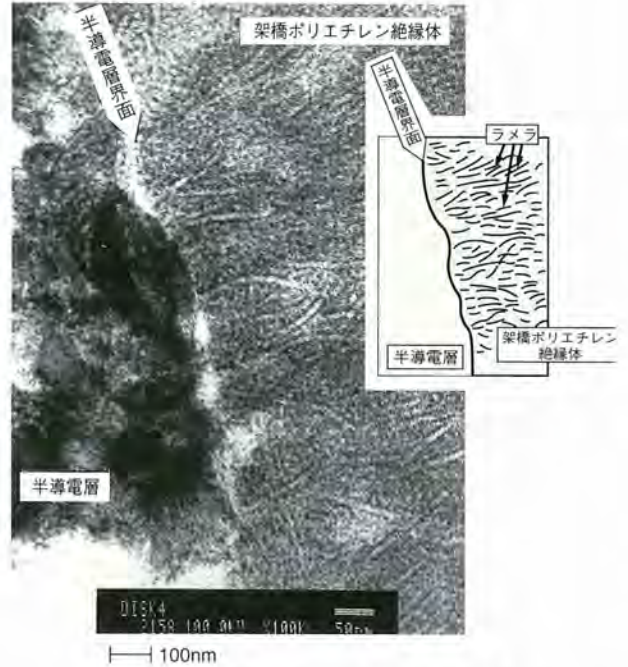
図3-1-5 半導電層界面の電子顕微鏡写真例
