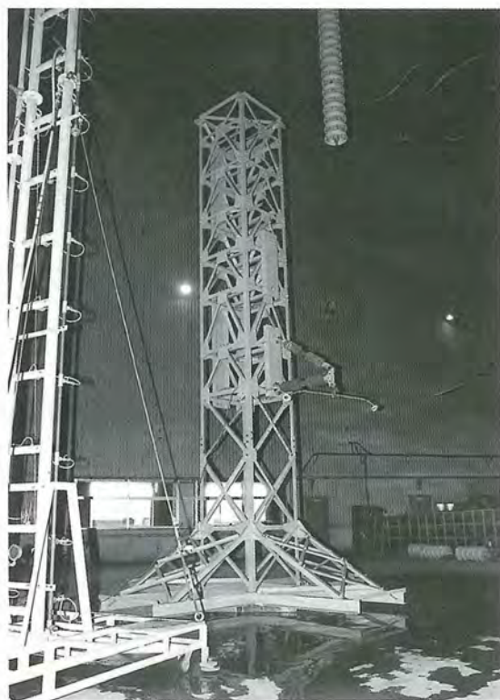
図2-2-3 絶縁アームの電気絶縁性能試験状況
