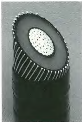
図3-3-1 絶縁厚9mmの実規模CVケーブル試料
