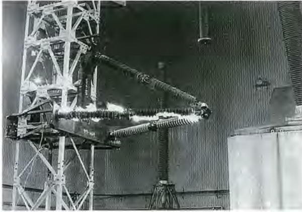
図2-2-4 汚損耐電圧試験前のフラッシュオーバー状況
