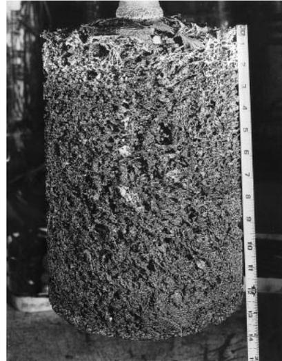
図4-1-2 個体陰極に析出したウラン(約10kg)
