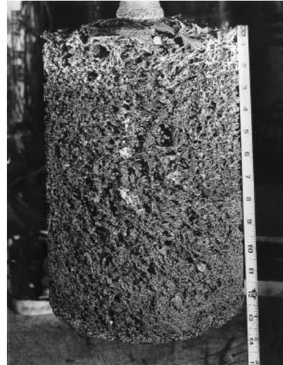
図4-1-2 個体陰極に析出したウラン(約10kg) (ANL/電中研共同研究)
