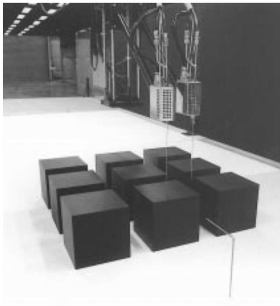
図3-2 濃度測定の様子(風洞実験)
