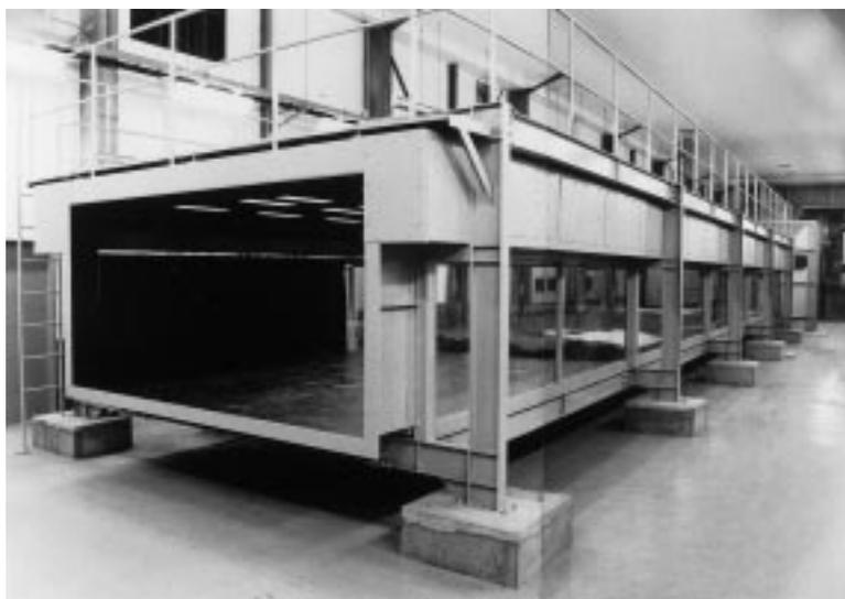
図2-1 電力中央研究所の大気拡散実験用風洞
