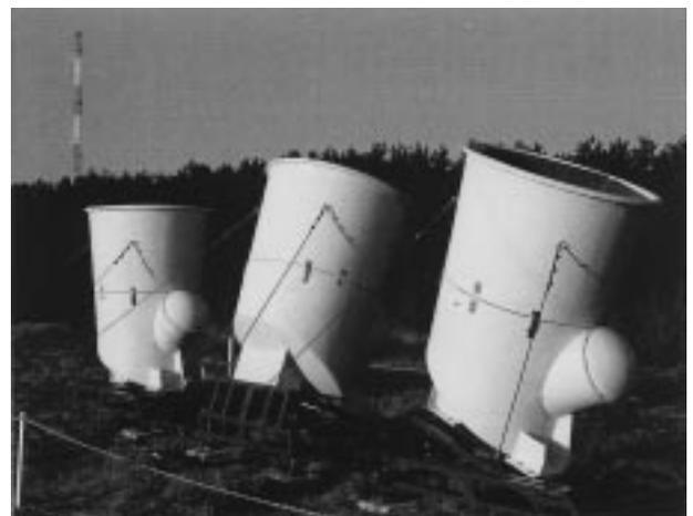
図4-8 原子力発電所構内で実用化試験中のドップラーソーダ
