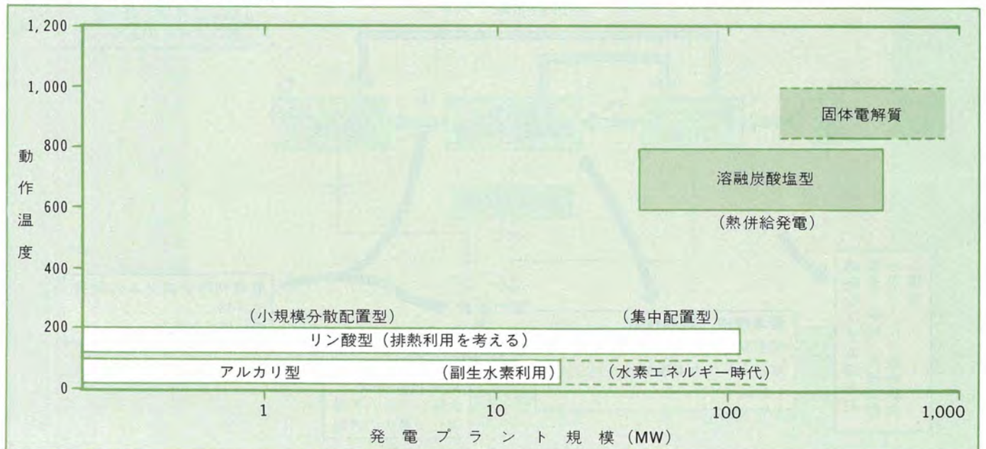
図2-2-1 各種燃料電池の動作温度領域
