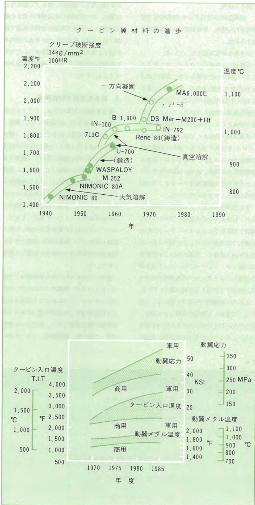
図2-1-13 超合金の進歩とガスタービンの高温化
