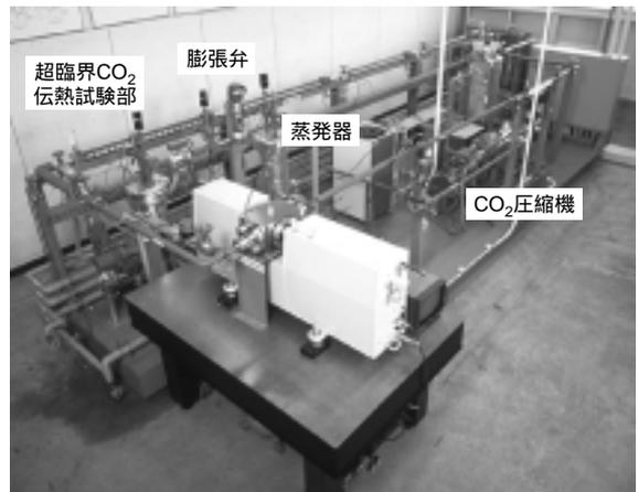
図3-3-5 CO<sub>2</sub>ヒートポンプ伝熱ループ試験装置
