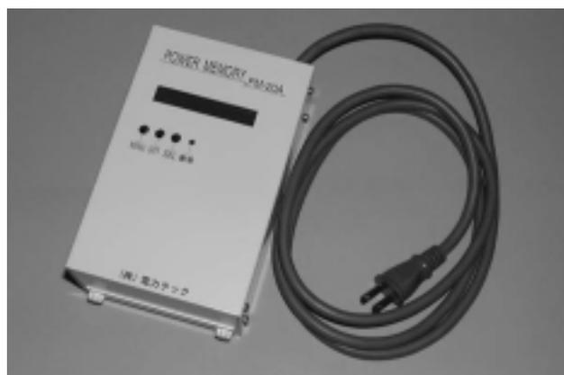
図3-4-1 消費電力測定記録装置
